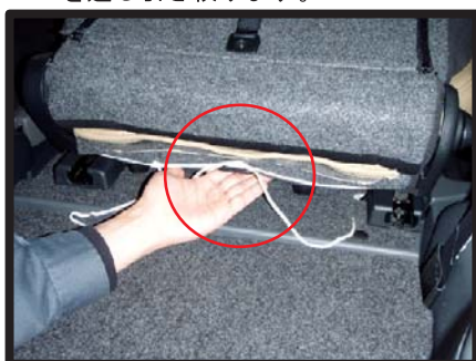
⑥固定したヒモをチャイルドシート固定用フックの上に引っかけます。
