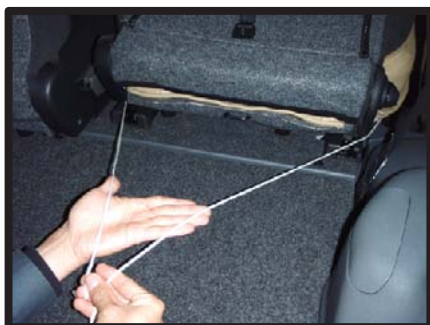
⑤カバー後ろ側から出ているヒモを座面後ろに引き出します。引き出したヒモを座面後ろで固定します。片側のヒモで輪を作り、反対側のヒモを通し引き絞ります。
