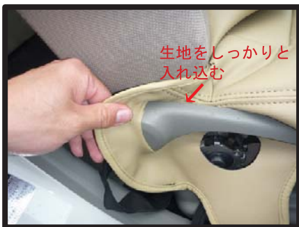
⑪カバーをかぶせます。 始めにリクライニングレバーをカバーの加工穴に通します。レバーの根本にしっかりと生地を入れ込みます。
