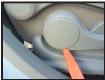
⑧シートリフターのレバーを外します。 丸いプラスチックを外します。
