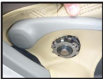
⑫生地伸びを利用して、ゆっくりとレバーを抜き出します。作業は慎重に行ってください。カバーの加工穴からシートリフターの軸を出します。
