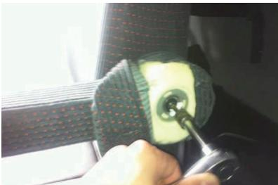
2 アームレスト本体の生地をめくり、トルクスレンチ（T30）を使用し、ボルトを外すことでアームレストが取り外せます。
