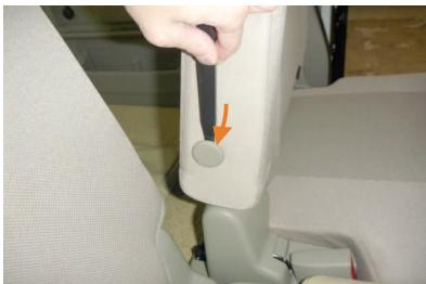
1 助手席側はシート内側面に付いているアームレストのフタを外し、ソケットレンチ等(12mm)を使用してアームレストを外します。
