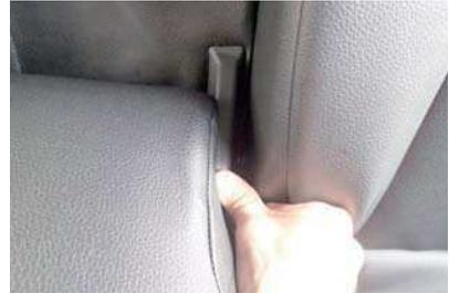
10 軸の金属部分にプラスチックパーツを元に戻します。突起部とツメの位置を意識してしっかりとめ込みます。一度固定した後にアームレストを動かしてしっかりと固定されているか確認して下さい。
