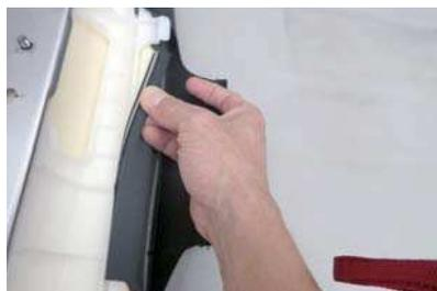
11 サイドパーツ側面の純正シート地の固定を外します。純正シート地には先端にプラスチック部材が付いて、隙間にはめ込まれているので、指で抜き出します。
