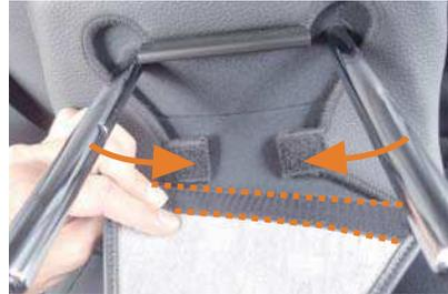
10 ヘッドレストをシートから外します。ヘッドレストの裏側で生地を内へ寄せながらマジックテープを固定します。1列目同様にブラックを固定します。
