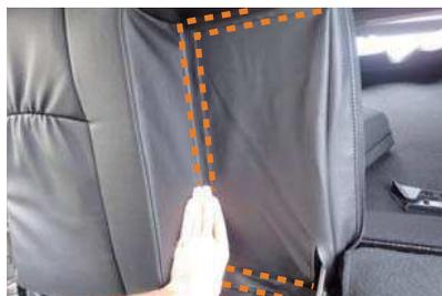
23 アームレスト収納部の下側も角をしっかりと合わせて、マジックテープを直接シートに貼り付けて固定します。
