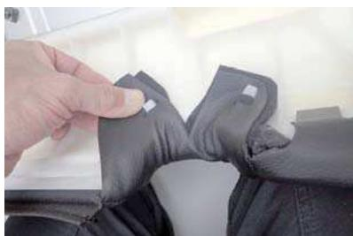
9 内側の下に純正シート地が2か所ツメで引っ掛けて固定されています。その上からカバーも同様に、ツメにカバーの切り込みを引っ掛けて固定します。
