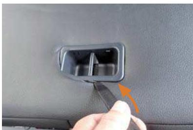
28 シート背面のシートを固定するアンカー部分のフチに、ヘラなどを使用して生地を入れ込みます。こちらの隙間は大変狭くなっています。作業は慎重に行ってください。
