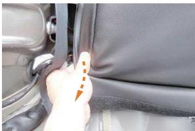
20 シート外側の付け根部分です。シートのラインに添わせるようにカバーを馴染ませます。
