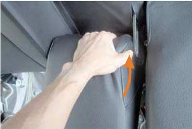
8 プラスチックパーツを外している、金属部分に注意してアームレスト入れ込みます。アームレストを起こした状態だと生地が引っ掛かりやすくなります。アームレストを出した状態で作業を行います。
