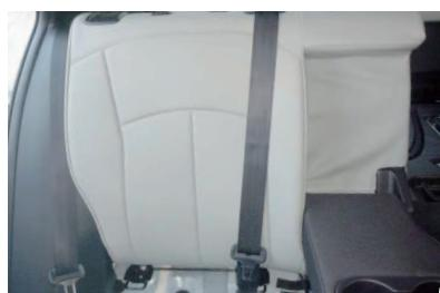
21 カバーのラインを整えて、2列目運転席側背もたれカバーの完成です。アームレスト収納部はアームレストカバー装着後、アームレストをしづらく背もたれ側に収めた状態にしておくと生地がシートに馴染んでいきます。助手席側も形状は異なりますが、同様に取り付けます。
