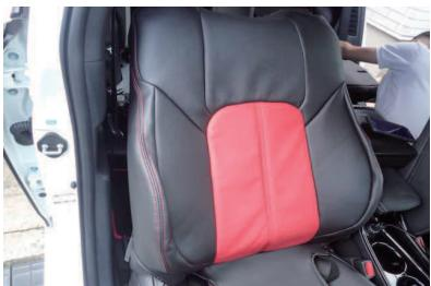
2 シートのラインに合わせて、カバーをシート全体にかぶせます。この際、カバーの先端が張るまでしっかりとかぶせて下さい。
