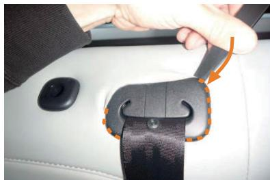
19 中央シートベルトのフチに、ヘラなどを使用して生地を入れ込みます。中央シートベルトのプラスチック部はツメが外れやすくなっているので、作業は慎重に行って下さい。
