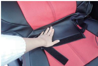
4 背もたれと座面の隙間に生地を入れ込みます。シートを前方へ倒しておくと、生地が入れ込みやすく、スムーズに作業が出来ます。
