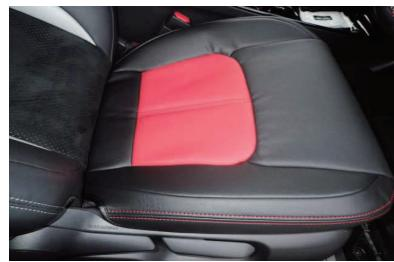
11 カバーのラインを整えて、1列目運転席座面の完成です。助手席も同様に取り付けます。
