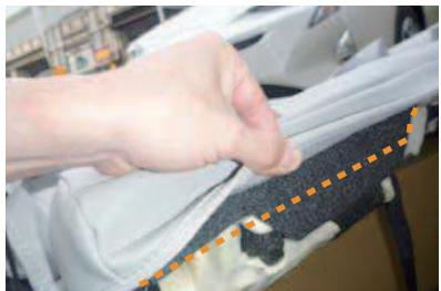
8 シート背面の両端に、カバーのマジックテープを直接貼り付けて固定します。
