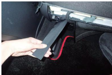
7 5番で入れ込んだマジックテープを引き出します。マジックテープは配線の外側に来るように中央部分から端へずらし、引き出して下さい。マジックテープ部分は強く引き過ぎると生地が破れたり、縫製糸が切れるので、慎重に作業を行って下さい。
