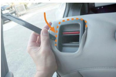
18 リクライニングレバーのフチに、ヘラなどを使用して生地を入れ込みます。リクライニングレバー部のプラスチック部はツメが外れやすくなっているので、作業は慎重に行って下さい。
