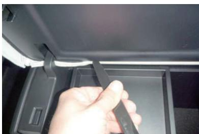
5 ここからはひたすらフチに生地を入れ込んでいきます。ヘラなどを使って生地を入れ込みます。アームレストのフタを開けた状態で作業をするので、破損させないように入地を入れ込む際は、フタ部分をしっかりと支えて作業を行って下さい。
