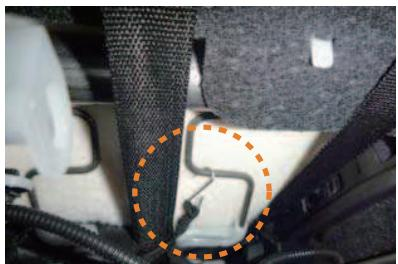
**14** シートの底面には図のように金属部分がいくつあるので、その部分にゴムが届く範囲で引っ掛けで固定をします。
