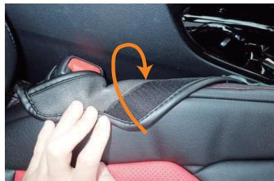
10 カバー内側面のマジックテープをシートに直接貼り付けて固定します。隙間が狭いので、シートの位置を調節して入れ込みやすい位置で作業を行って下さい。
