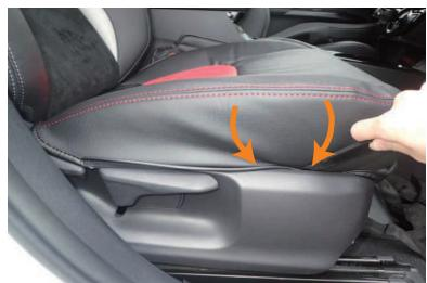
9 外側面の固定用部材をヘラ等を使用してシートのプラスチックの中へ入れ込みます。固定用部材が見えなくなるまでしっかりと奥まで入れ込んで下さい。
