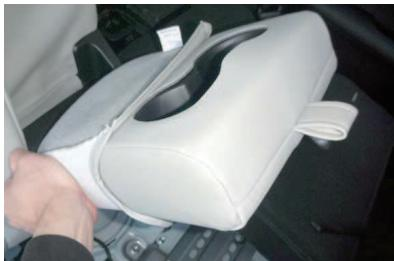
1 カバーの入り口を裏返して、アームレストのラインに合わせてかぶせます。この際アームレストの先端まで生地が張るように、しっかりととかぶせて下さい。
