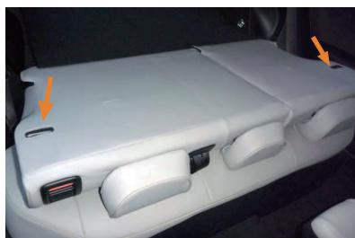
20 図のシートを固定する受けの部分にカバーの加工穴があっているか確認して下さい。加工穴は少し大きめに開けていますが、すべて受け部分を塞いで使用すると、生地が破れる恐れがあるので、ご注意下さい。
