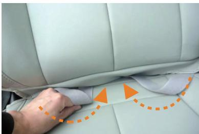
5 生地の両端に付いているマジックテープをシートの隙間が広い中央部分から入れ込みます。この際、ねじれないように注意して入れ込んで下さい。背もたれを後ろへ倒した際に、マジックテープが見えなくなるまでしっかりと入れ込みます。
