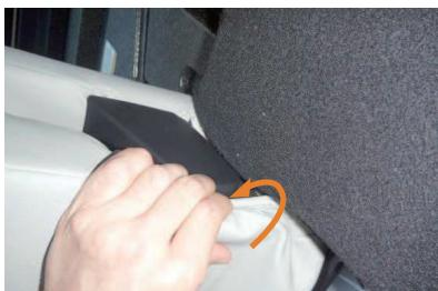
2 アームレストの助手席側付け根部分に、生地を巻き付けるようにかぶせます。
