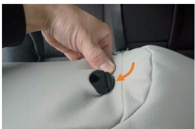
3 ヘッドレストの台座をカバーの加工穴から出します。台座のフチに生地をしっかりと入れ込みます。
