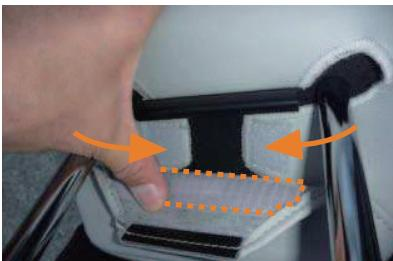
9 ヘッドレスト裏で生地を内へ寄せながらマジックテープを固定して、1列目同様にプラフックを固定します。
