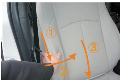
8 図の①～③の手順でシートにカバーを馴染ませます。①シートラインに沿わせる様に生地を流します。②余った生地を中心へ寄せます。③寄せた生地を下へ流して6番と同様に背面から引き出します。全体的にたるみや浮きがなくなるまでこの作業を繰り返し行って下さい。
