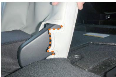
14 シートの内側です。アームレスト軸部分のプラスチック部のカバーは、図のような形状をしています。
