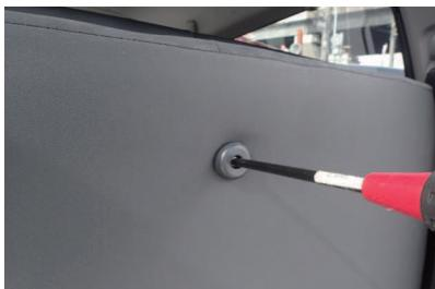
9 背もたれ背面に、図のようなプラスチックパーツが付いている場合は、カバー装着前にプラスドライバーを使用し、取り外しておきます。
