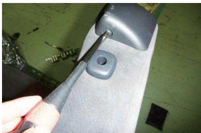
1 シートベルトガイド側面部のネジをプラスドライバーで外します。
