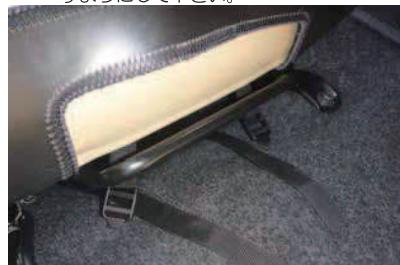
5 ベルトを前側から引き出し、カバー前側に付いているバックルに固定します。
