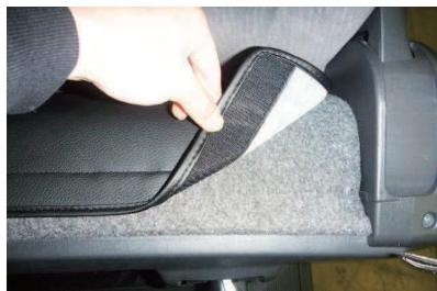
4 入れ込んだ生地を、シート背面側から引き出し、マジックテープでシートに直接固定します。
