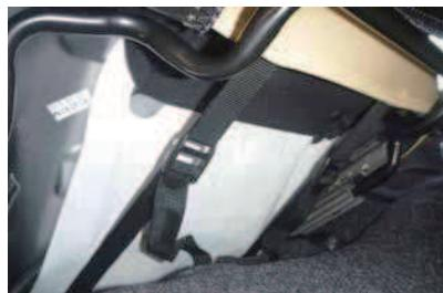
6 バックルは、図のようにシートスライドバーの上側を通すようにして下さい。
