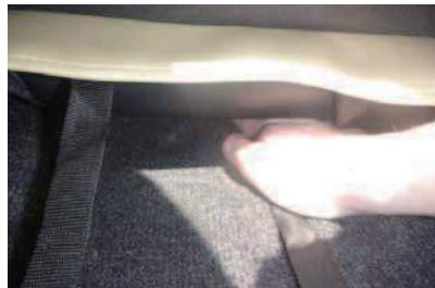
4 入れ込んだ生地を、背面側から引き出します。引き出した生地に付いているベルトをシートの底面から前側に通します。
