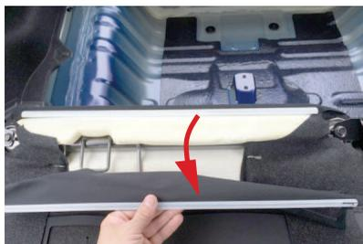
7 シート表皮をめくり上げると図のようにシートのスポンジ部分が見えます。
