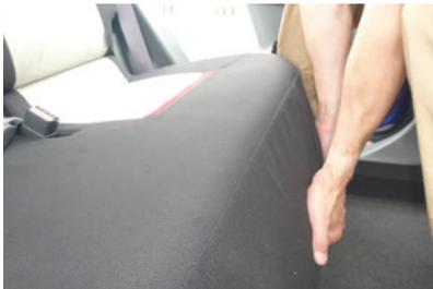
1 シートはシート裏のフックで固定されています(2番参照)。シートの裏に手を入れフックのすぐ横を持ち、カいっばい真上に持ち上げるとフックが外れ、シートの前側が持ち上がります。フックはシートの裏に左右2か所で固定されています。
