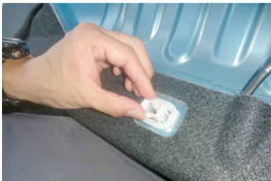
4 3番の部品がツメ側に付いてきた場合は、部品をツメから外して車体側の受けに戻して下さい。シートを元に戻す際にツメ側に付いていると戻り辛くなります。
