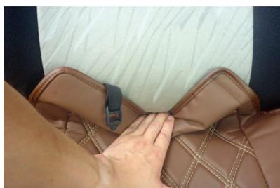
9 背もたれと座面の隙間に生地を入れ込みます。背もたれの角度を調整して入れ込みやすい角度で行ってください。
