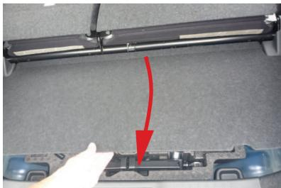
5 車の外へ出てトランク側から図のラゲージボードを取り出します。
