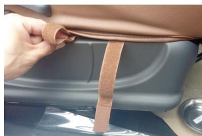
12 カバー外側にマジックテープのベルトが2本付いています。マジックテープのベルトをシートとプラスチックカバーの隙間に入れ込みます。
