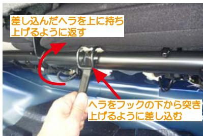
7 シートの背面側の付け根に、図のフックが金属バーに掛かっています。フックの下側にヘラなどを差し込み、てこの原理のようへらを動かして、フックを金属バーから外します。
