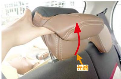
7 2列目中央ヘッドレストです。2列目ヘッドレストは図の矢印の方向に、下から上へかぶせます。まずヘッドレストの先端部分の生地に、たるみなどが出ないようにしっかりととかぶせます。
