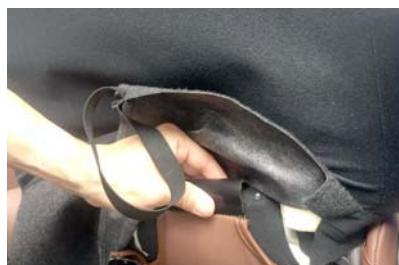
12 8番で引き出した生地に付いているフックを、図のようにシート背面裏の縁に引っ掛けで固定します。座面カバーを装着する際に外した5ページ1番、助手席は9ページ2番の生地を、ゴムが完全には外れていませんが、しっかりとめくり上げて作業を行って下さい。
