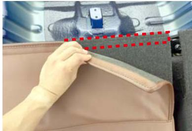
15 15番でめくり上げていた生地を元に戻して、カバーに付いているマジックテープをシートに直接貼り付けて固定します。
