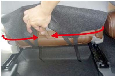
13 カバー側面の後ろ側に付いているマジックテープ同士を、図のようにシート背面から中央へ寄せて固定します。
