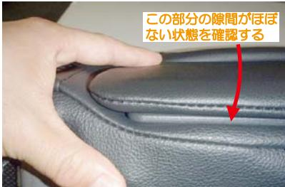
13 ボックスをアームレストに戻した際に、図の矢印の隙間がほぼない状態になっていることを確認して下さい。ボックスが少し浮いた状態の場合は、ボックス裏のツメがかかっていません。再度ボックスを取り付け直して下さい。
