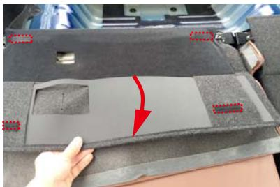
7 シート背面下の生地をマジックテープの固定（点線部分）を外してめくり上げます。
