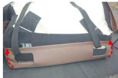
10 シートの付け根部分に、カバーを包み込むようにかぶせます。9番で通したベルトはカバーの加工穴にも通して引き出します。
