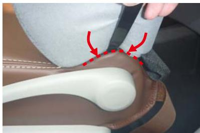
8 シートの軸部分に生地を引っ掛けるようにして、ヘラなどで入れ込みます。シート内側も同様に生地を入れ込みます。
