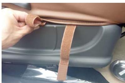
12 カバー外側面にマジックテープのベルトが2本付いています。マジックテープのベルトをシートとプラスチックカバーの隙間に入れ込みます。
