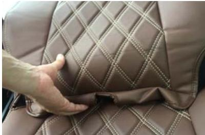
7 背もたれと座面の隙間に生地を入れ込みます。生地の端には大きなフックが付いているので、フックの角などで生地を傷付けないようにご注意下さい。
