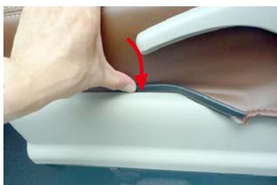
9 カバー外側面の生地をシートとプラスチックカバーの隙間に入れ込みます。
