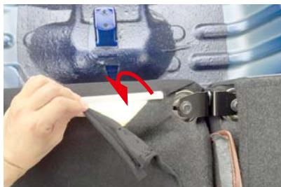
8 シート背面下で、シート表皮の固定を外します。シート表皮はフックに平らなプラスチックを入れ込み固定されています。平らなプラスチック部分を手前に返すようにするとフックから外れます。
