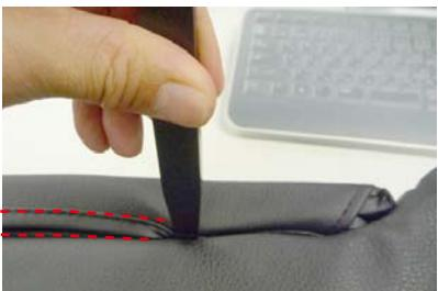
14 アームレストとボックス部分の隙間に、ボックスのフタに付けたカバーの端を、ヘラなどを使用して入れ込みます。点線で囲んだ生地のフチ部分が全て見えなくなるほどしっかりと入れ込んで下さい。
