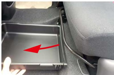
1 始めにシートアンダートレイを外します。トレイをいっぱいまで引き出して、上下に軽く振りながら引くと、トレイが図のように外れます。
