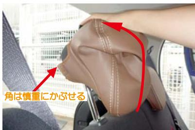
8 ヘッドレスト全体にカバーをかぶせます。ヘッドレスト後ろ側の角部分は、一番装着がきくなるところです。角の部分を指で押し込みながら、慎重にカバーをかぶせて下さい。
