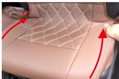
3 カバーをシートのラインに合わせて、前側から後ろ側へかぶせていきます。
