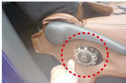
7 シートリフターの軸にカバーの加工穴を合わせます。
