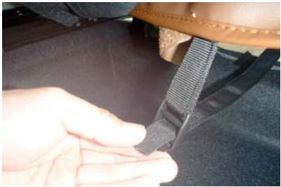
19 6ページ10番で引き出した生地の端に付いているバックルに、7ページ16番で引き出したベルトを通して固定します。
