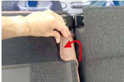
13 20ページ7番の生地をめくり上げた状態で、カバー両側面の下側に付いているマジックテープを、シートに直接貼り付けて固定します。マジックテープに保護テープが付いている場合は、保護テープを外してから固定して下さい。
