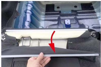
9 シート表皮をめくり上げると図のようにシートのスponジ部分が見えます。
