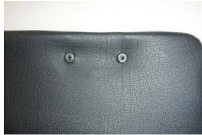
10 切り込んだ部分からネジ穴を図のように取り出します。
