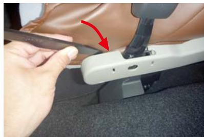
11 シートベルトバックルの付け根部分にも生地を入れ込みます。
