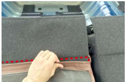
15 カバー背面の生地をめくり上げて、図の点線の位置にカバーのマジックテープを、シートに直接貼り付けて固定します。
