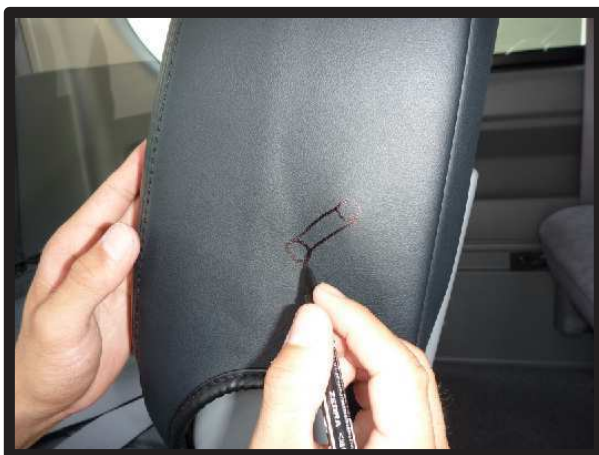
⑫GLはアームレストの穴開け加工が 必要です。ボルトの穴と突起の位置 に印を付け、それをつなぐように穴 を開ける型を取ります。
