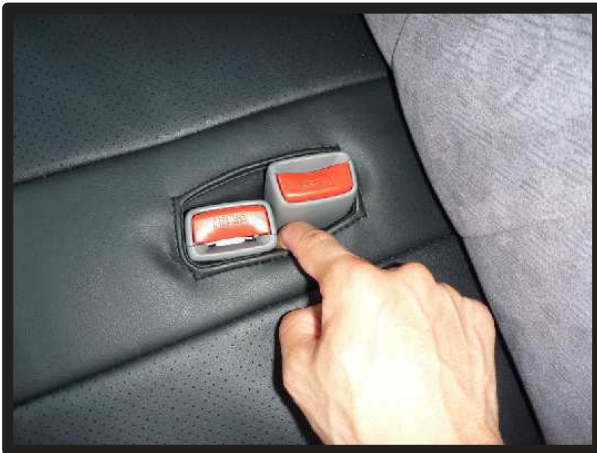
⑭シートベルトのバックルが出ている穴のフチに生地を入れ込みます。
