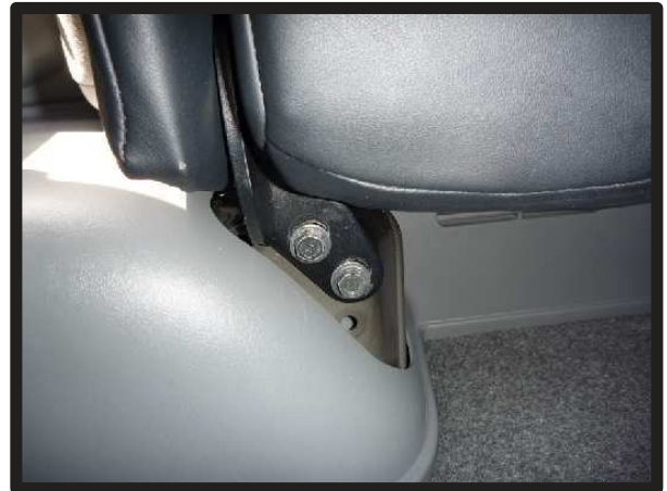
⑪ 8 ページの②で外したステーを元に戻します。
