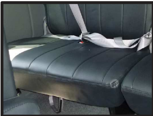
⑮GL 4列目座面の完成です。 助手席側も同様に取り付けます。
