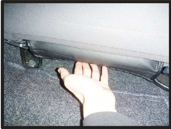
⑦引き出した生地のマジックテープをシートに直接固定します。
