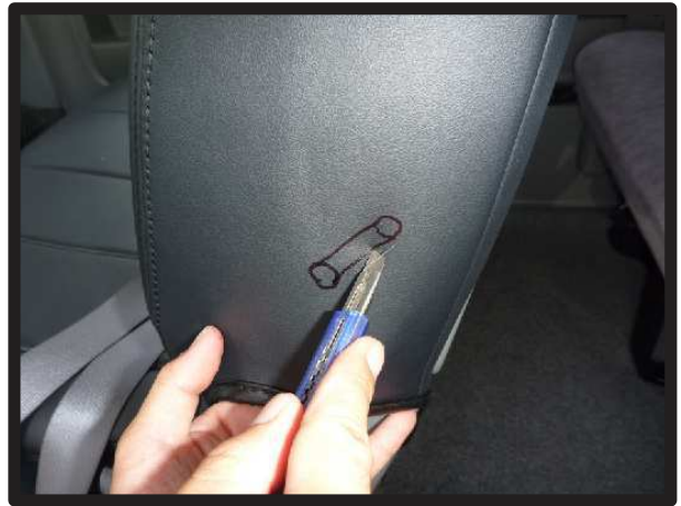
⑬型に沿って生地を切ります。 シート本体を傷付けないようご注意 下さい。
