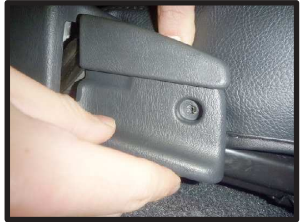
⑩プラスチック部分を浮かせて隙間から生地を入れ込み、カバーの加工穴の位置を突起部に合わせてネジを元通りに締めます。
