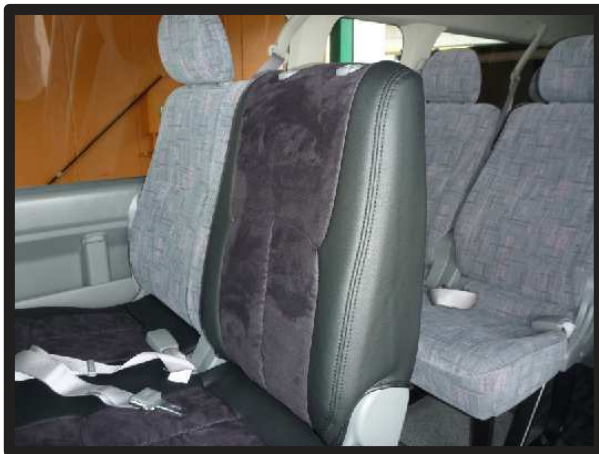
⑪ヘッドレストの台座を取り出し、後 席背もたれの完成です。 グランドキャビンの4列目はバック ボードはありませんが、同様の固定 方法で取り付けを行って下さい。
