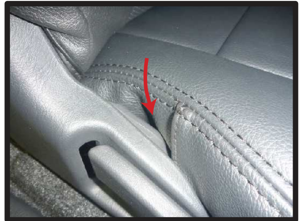
⑪シート外側面のリクライニングレバー周りの生地をシートの間隙に入れ込みます。 多少形状は異なりますが内側面も同様に生地を隙間に入れ込みます。
