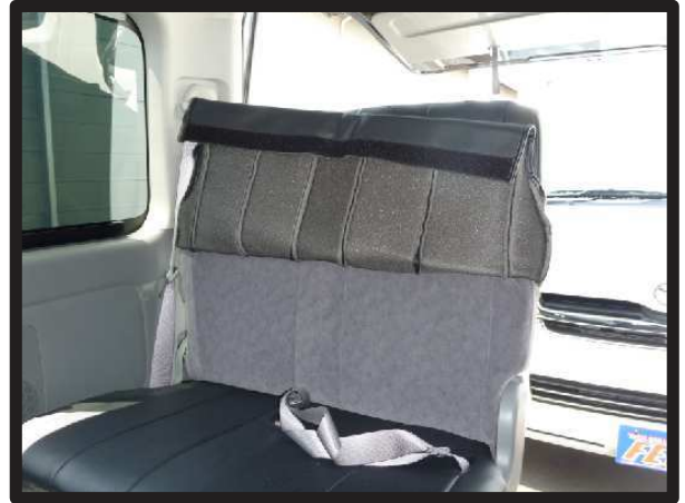
①カバーを半分ほど裏返してシートのラインと合わせ、肩口までしっかりと入れ込みます。
