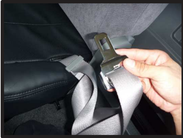
⑬カバーの加工穴からシートベルトを取り出します。
