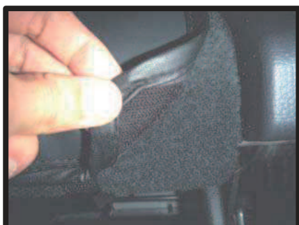
⑪引き出した生地裏側に付いているマジックテープをシートに直接固定します。
