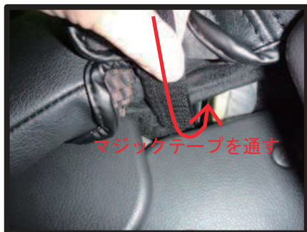
⑦左右に付いているマジックテープはプラスチックの間を通します。
