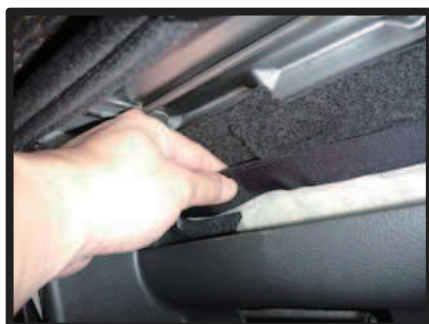
⑨マジックテープをアウトマン裏側で固定します。
