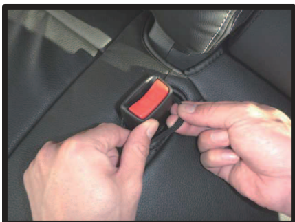
⑱シート中央にあるシートベルトバックルをカバーの加工穴から引き出し、加工穴に付いているゴムを、図のようにバックルの根元に固定します。
