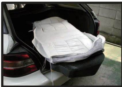
⑩純正のシートのラインに合わせて座面にカバーを被せます。
