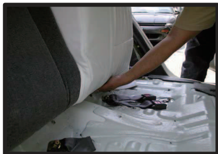
⑧マジックテープ部を背面と座面の間に入れ込みます。
