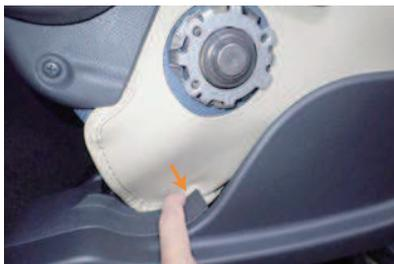
**19** シートを下した際、生地が外に出ないようにする為、シートリフター下の生地は、図のようにプラスチックカバーの隙間に入れ込みます。
