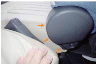
**21** シートベルトバックル収納部分の生地を、プラスチックカバーの隙間に入れ込みます。
