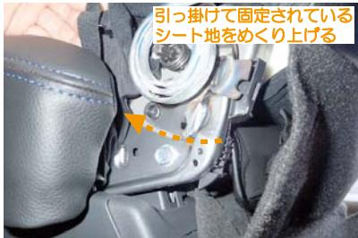
25 6ページ12番でプラスチックパーツを外した後の部分です。図のように純正のシート地をめくり上げて金属部分が剥き出しなっている状態にします。
