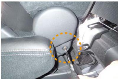
27 プラスチックパーツを生地を挟み込み元通りに固定します。6ページ11番のツメを先に引っ掛けで固定して下さい。
