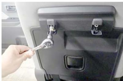
3 2番で開いたキャップの内側にボルトがあります。ボルトをソケットレンチなどを使用して外します。
