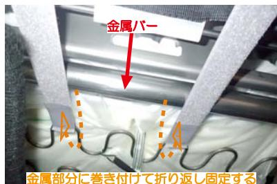
18 マジックテープのベルトはシート裏の金属部分に巻き付けて固定します。
