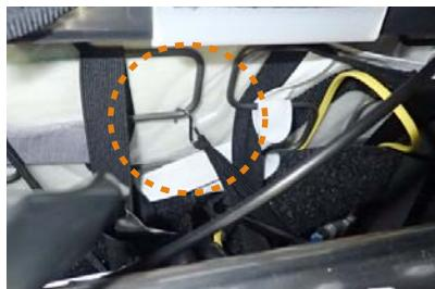
34 金属フックをシート裏の金属部分に引っ掛け固定します。
