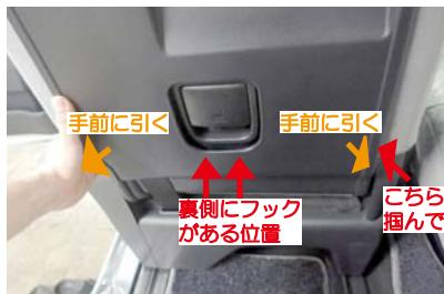
5 シート背面のバックボードをシートから外します。
