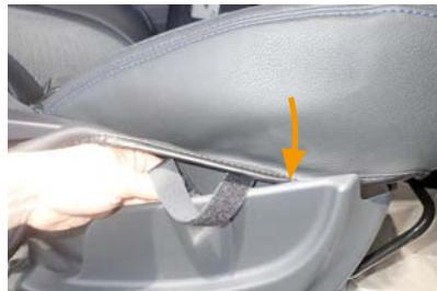
16 カバー外側に付いているマジックテープのベルトとカバーの端を、シートとプラスチックパーツの隙間に入れ込みます。
