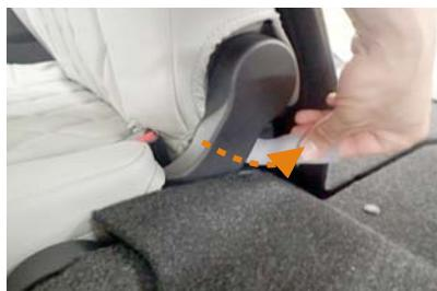
5 シート内側の軸部分です。カバーの端にマジックテープが付いています。マジックテープを軸の内側を通して、シートの背面から引き出します。
