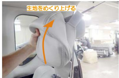
1 ※2列目ヘッドレストは2種類あり、2種類のシートカバーを同梱しています。ファブリックシートはカバーのタグに20HRと印字しているものを、ソフトレザーティートは20HR中央と印字しているカバーを使用して下さい。
