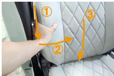
26 ①~③の順番に、カバー側面の生地を引き下げながら中央へ寄せて、中央で余った生地を下へ撫で下ろします。シートの下に余った生地を13ページ17番と同様にシート裏から引き出して、生地をシートに密着させていきます。
