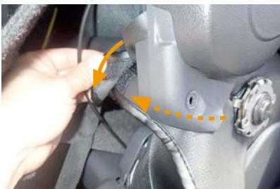
20 引き出した生地の端と、7ページ17番でプラスチックパーツの内側を通した生地の端を、マジックテープで固定します。
