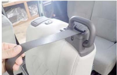
42 シートカバー装着後、図のようにシートベルトを引っ張り、手を放して問題なくシートベルトが巻き取られるか確認して下さい。
