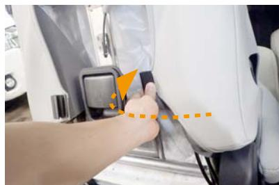
23 カバー側面の生地をシートに馴染ませながら、シート背面で純正シート地を固定しているフックの上から、カバーのフックを引っ掛けで固定します。
