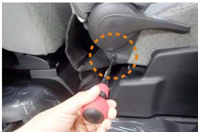
9 リクライニングレバーの軸の下側にあるネジを、ドライバーを使用して外します。
