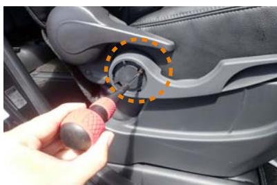
8 キャップを外すと中にネジが1本あります。そのネジをドライバーを使用して外すと、シートリフターのレバーが外れます。
