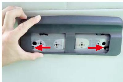
19 11ページ6番で外したシートバックテーブルを囲っているプラスチックパーツを、元に戻します。
