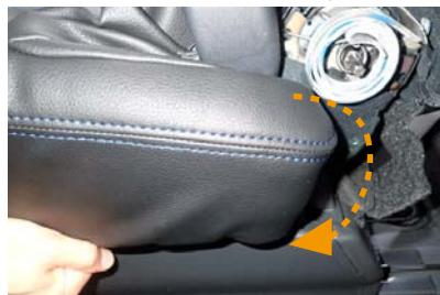
14 シートの内側からカバーをかぶせます。シートの内側の図の部分はカバーが袋状になっています。シートに引っ掛けるようにしてカバーをかぶせます。
