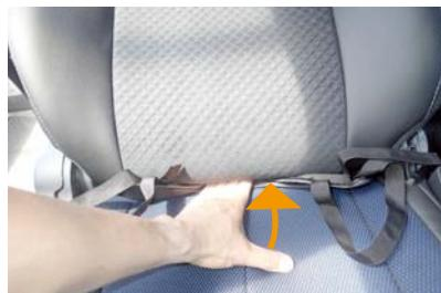
18 背もたれと座面の隙間に生地と生地に付いているベルトを入れ込みます。背もたれの角度を調整して、入れ込みやすい位置で作業を行って下さい。
