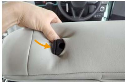
14 ヘッドレストの台座を取り出します。まず台座の片側のフチに、生地をしっかりと入れ込みます。
