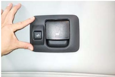
25 プラスチックパーツを生地を挟み込み元通りに固定します。ツメの位置に生地が覆い被さっているとしっかり固定できないため生地を外側に避けながら固定して下さい。
