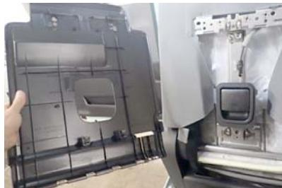
14 シートベルトを外すと図のように完全にシートからプラスチックボードが外れます。
