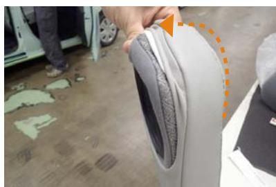
2 カバーをアームレスト全体にかぶせます。アームレストの後ろ側にカバーをかぶせていく際は、慎重に作業を行って下さい。
