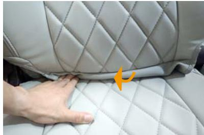
16 背もたれと座面の隙間に生地を入れ込みます。入れ込む生地にはフックが付いています。フックで座面カバーを傷付けないように、注意して下さい。
