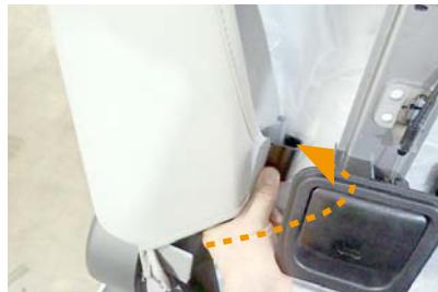
24 反対側の側面も同様です。純正シート地を固定しているフックの上から、カバーのフックを引っ掛けで固定します。
