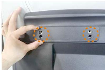
38 26ページ35番でプラスチックパーツを外している場合は元に戻します。ボルトの穴位置がしっかりとプラスチックパーツの中心に来ているか確認して下さい。
