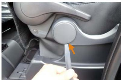
7 シートリフター装備車はレバーを外します。まずレバーの軸部分にあるキャップをヘラなどを使用して外します。
