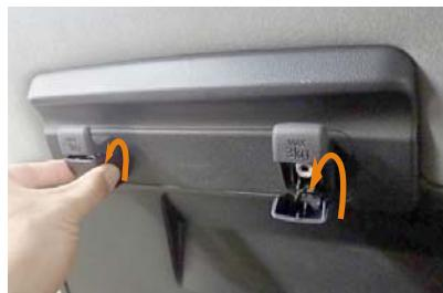
2 シート背面のバックボードからコンビニフックを外します。
