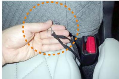
16 シートベルト収納部の端にゴムが付いています。ゴムに付属の金属フックを取り付けてシート裏へ入れ込み、シート裏の金属部分に引っ掛けで固定します。
