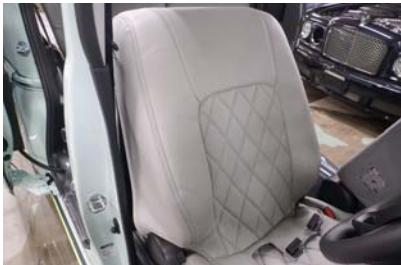
13 カバー側面のファスナーを開けた状態にして、シートのラインに合わせて、カバーをシート全体にかぶせます。
