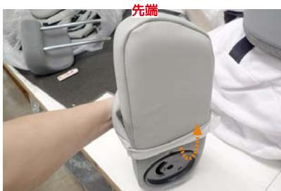
1 カバーの大きい方の加工穴から図のようにカバーを裏返して、アームレストの先端まで生地が張るように、しっかりととかぶせます。
