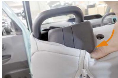
17 ファスナーを半分程度閉じた状態で、シートベルトが出ている台座部分をカバーから取り出します。
