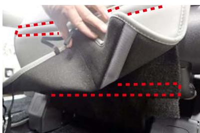
32 31番で固定した生地に、2本のマジックテープを直接貼り付けて固定します。
