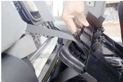
13 プラスチックボード下側の固定が外れると図のようにシートからプラスチックボードが外れます。
