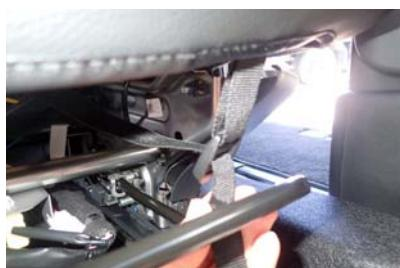
30 引き出したベルトをカバーの前側に付いているバックルに通します。
