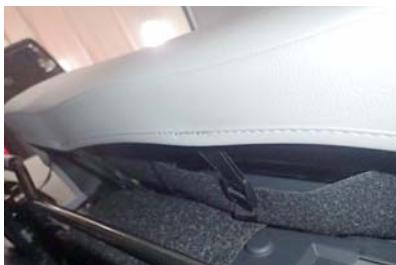
5 カバーの前側に付いているバックルとベルトを固定します。ベルトの固定方法は10ページ31番を参考にして下さい。
