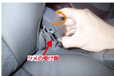
11 10番のプラスチックパーツをシートから外します。図のシート表面側から見た位置にプラスチックパーツのツメがあります。ツメの位置を意識して上へめぐり上げるようにして外していくきます。
