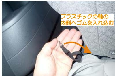
17 29ページ2番で引っ掛けた生地の端にゴムが付いています。ゴムに付属の金属フックを取り付けてシート裏へ入れ込み、シート裏の金属部分に引っ掛けで固定します。ゴムは図のプラスチックの軸の内側を通してシート裏へ入れ込むようにして下さい。
