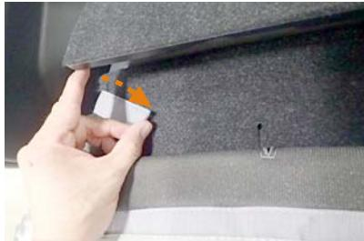
7 32ページ4番でシートの背面から引き出したマジックテープを、直接シートに貼り付けて固定します。
