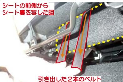
4 入れ込んだベルトをシートの前側から引き出します。この際、図の点線で囲んでいるシート裏部分の上にベルトを通すようにして下さい。
