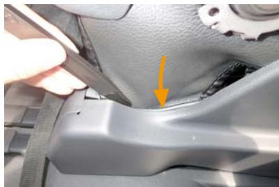
23 シートリフター装備車はシート下の図の隙間に、端に固定部材の付いた生地をへうなで入れ込みます。この隙間は固定部材が完全に入り込むほど奥行きがありません。固定部材が途中で引っ掛かる程度に入れ込んで下さい。
