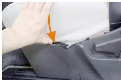
11 カバー外側の固定部材の付いた生地を、生地と一緒にプラスチックパーツの隙間に入れ込み固定します。
