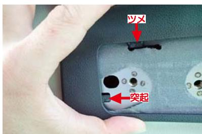
20 プラスチックパーツを戻す際は上側のツメと、19番の矢印位置にある突起部分もシートの穴位置に合わせて元通りに固定します。この突起が外にはみ出ているとプラスチックパーツがシートから浮いてしまうので、注意して下さい。
