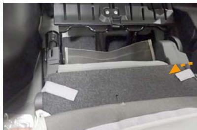
8 32ページ5番でシートの背面から引き出したマジックテープも、直接シートに貼り付けて固定します。
