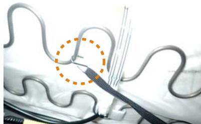
16 金属フックをシート裏の金属部分に引っ掛け固定します。
