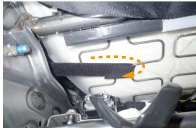
22 マジックテープのベルトはシート裏側の金属部分に巻き付けて、マジックテープ先端のオス部分をメスの部分に貼り付けて固定します。
