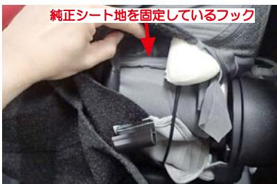
27 シート背面の5ページ6番で固定を外した生地を少々強引にめくり上げた図です。図の矢印の辺りに純正シート地を固定しているフックがあります。
