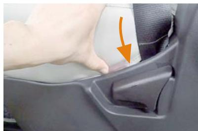
12 カバー外側の後ろ側も、固定部材の付いた生地を、生地と一緒にプラスチックパーツの隙間に入れ込み固定します。
