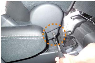
10 9番と同様に、シート内側のシートの軸になる部分のプラスチックパーツ下側のネジを、ドライバーを使用して外します。
