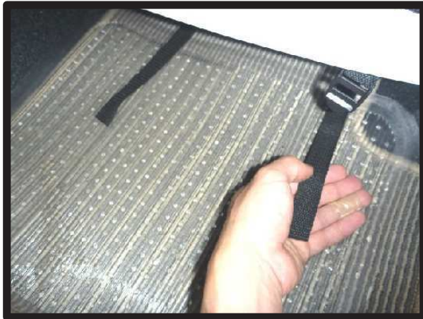
③② シート背面からベルトを引き出します。ベルトを3ページ⑮で引き出した生地が付いているバックルに通して固定します。
