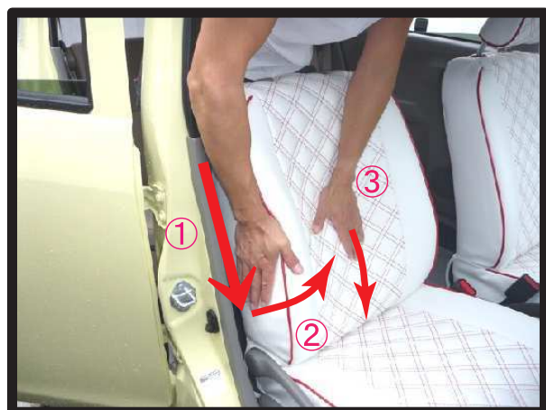
⑧①→②→③の手順で背もたれ側面の生地を、シートに馴染ませていきます。側面のシワが消えるまで繰り返し行って下さい。
