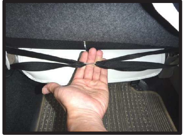
③④ カバー両側面の後部に付いているゴムを、シート背面からS字フックでゴムをつなぐように固定します。
