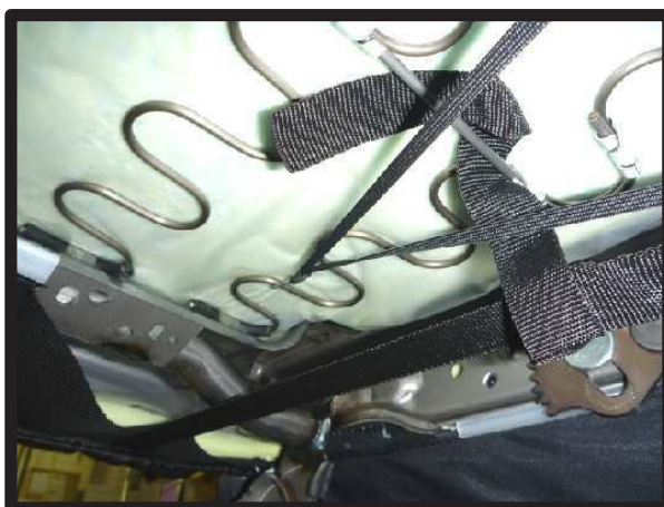
⑪S字フックはシート裏の金属部分に引っかけて固定します。
