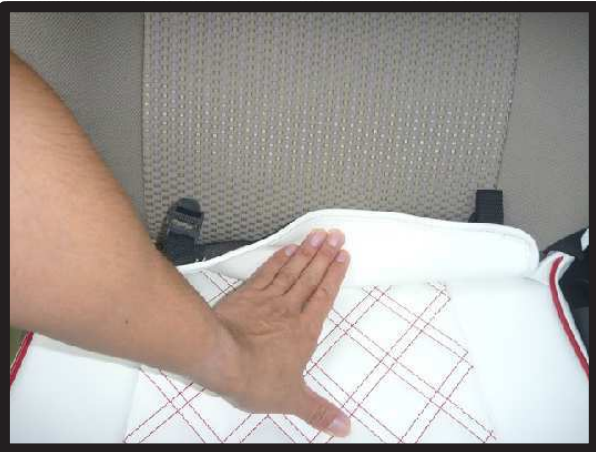
⑭背もたれと座面の隙間に生地を入れ込みます。背もたれの角度を調整して、入れ込みやすい位置で行ってください。
