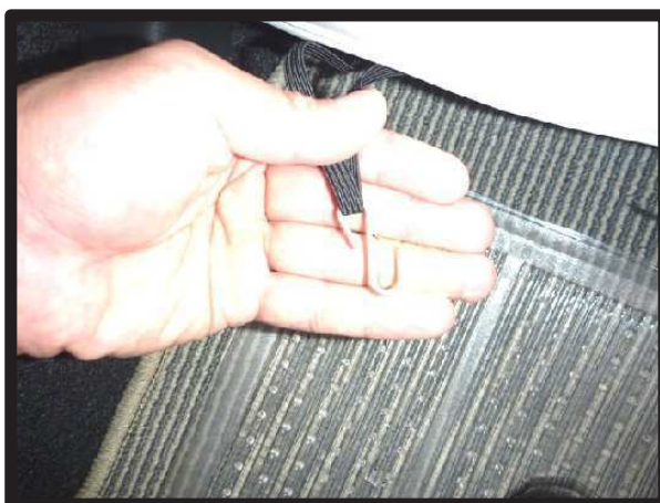
⑩カバー背面下に付いているゴムに、付属のS字フックを取り付けます。
