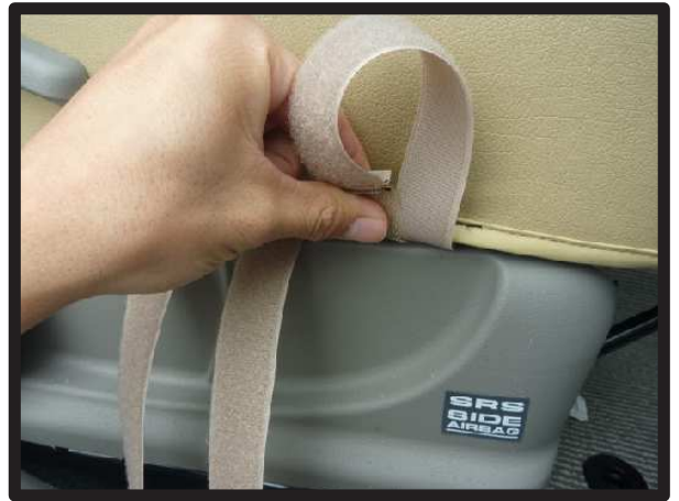
⑯カバー外側に付いているマジックテープのベルトを、図のようにシートとプラスチック部の隙間に入れ込みます（3本）。
