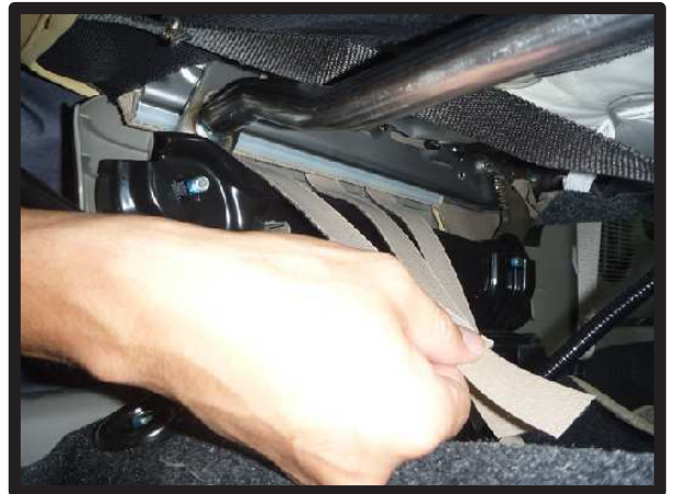
⑰入れ込んだベルトを、シート裏から引き出します。
