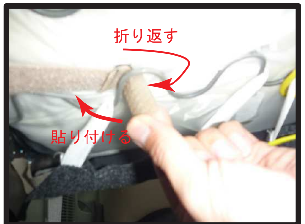
⑱ベルトはシート裏の金属部分に、引っかけて折り返し固定します
