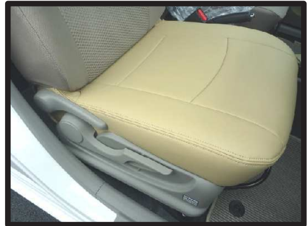
③⑤ カバーのラインを整えて、1列目運転席側座面の完成です。助手席側も一部形状は異なりますが同様に取り付けます。
