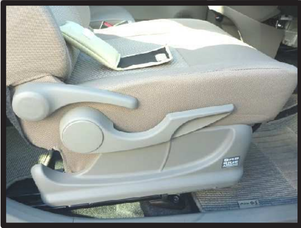
⑦シートを最大に上げた状態でカバーの取り付けを行います。
