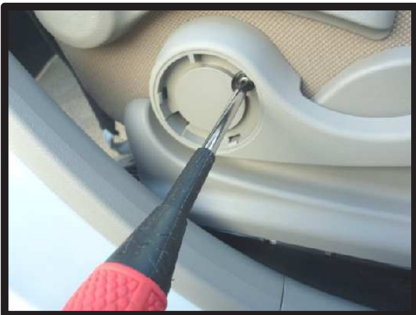
⑨ネジをドライバーで外します。
