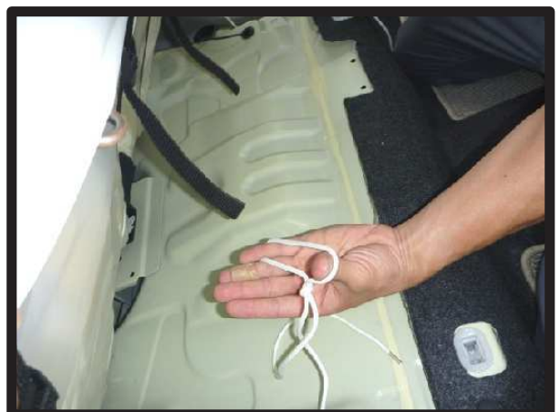
⑫カバー側面から出ているヒモの片側で、図のように輪を作ります。
