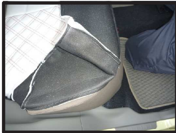
⑧カバーを裏返してシートのラインに合わせてみます。
